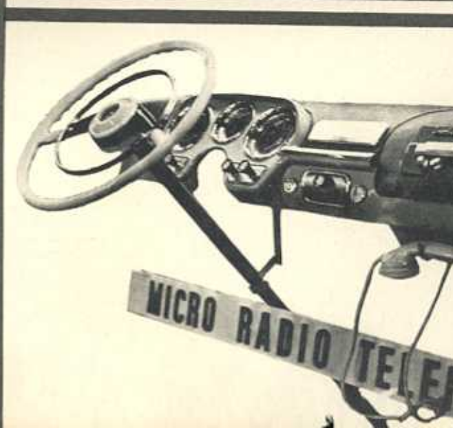
6 Il Micro Radio Telefono. Con questo apparecchio montato sul cruscotto della macchina, sia da fermi o in marcia, si può comunicare con qualsiasi abbonato alla linea urbana di una città per un raggio di 15 km.
