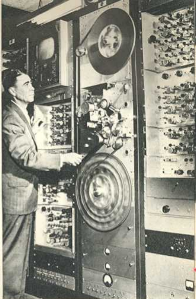
IL SISTEMA R.C.A. adopera matrici magnetiche di incisione e riproduzione fra bobine su questo quadro. Sono sufficienti 25 secondi per innestare e sintonizzare questo meccanismo di precisione ad alta velocità.
