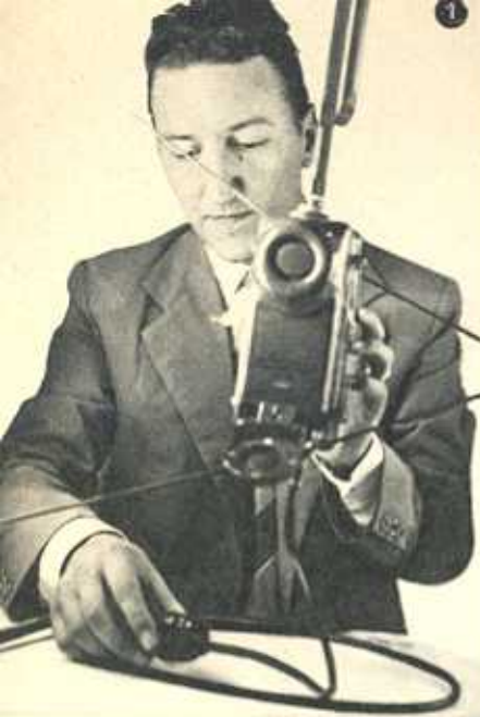
1 Apparato ricetrasmittitore portatile a modulazione di frequenza con antenna a frusta o « gold-plane ». Si chiama RT 101. Pesa kg. 1,650. Funziona entro il raggio di 50 chilometri.
